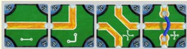
«Проводники» проводят ток в обоих направлениях. Они бывают прямыми, угловыми, двухугловыми и скрещивающимися. Провода скрещивающихся проводников не замкнуты друг с другом!
