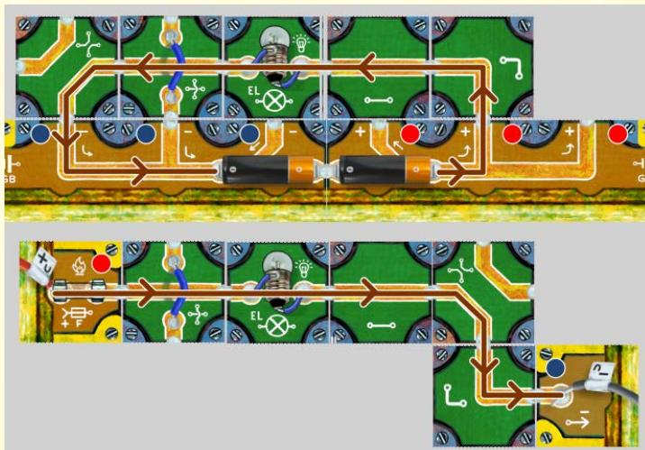
Диоды и светодиоды блокируют течение тока при неправильной полярности подключения.
