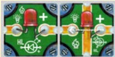
«Светодиод» работает аналогично диоду и также может блокировать течение тока в цепи, но дополнительно даст вам очки за свое «свечение». Следите за полярностью подключения, иначе света вы не дождитесь!
