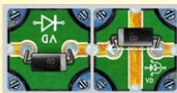
«Диод» пропускает ток только в одну сторону (схематично диод изображен стрелкой, указывающей это направление).
