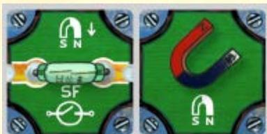
«Геркон» имеет упругие контакты, запаянные в герметичную стеклянную колбу. В обычном состоянии они разомкнуты, но стоит разместить рядом с герконом «Магнит», то через него потечет ток. При этом на жетон с герконом кладется жетон ВКЛ, показывающий его замыкание. Жетон ВКЛ убирается с геркона, если убирается замыкающий его магнит.
